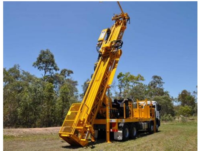
Figuur 2: Tipiese kernboorinstallasie
