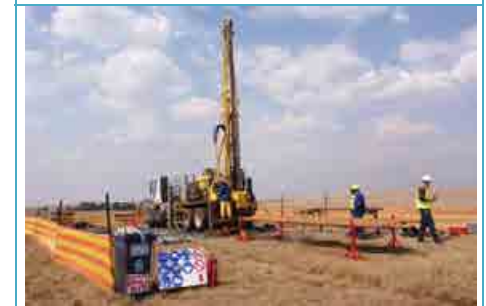
Figuur 3: Tipiese boortoring vir die boor van kernboorgate
