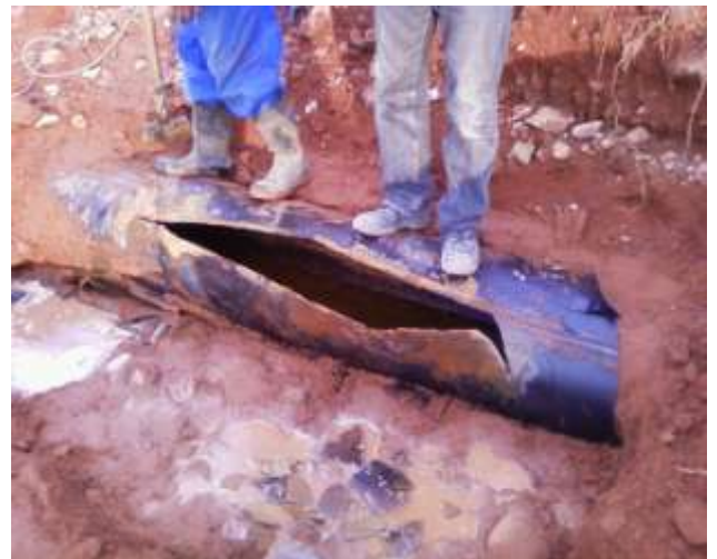
Typical pipe failure on the Eenriet to Vaalhoek gravity main
