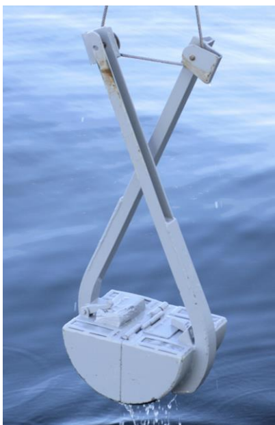
Figure 5. 'n Van Veen grab werk soos 'n klou om grond en makrofauna te "gryp" en op te skep.
