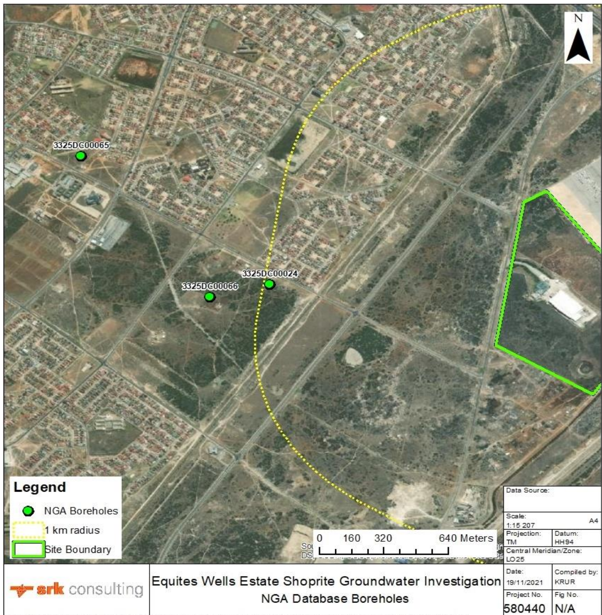
Figure 5: NGA Database Boreholes
