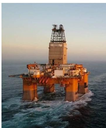
Figuur 2: Semi-onderwaterbooreenheid
