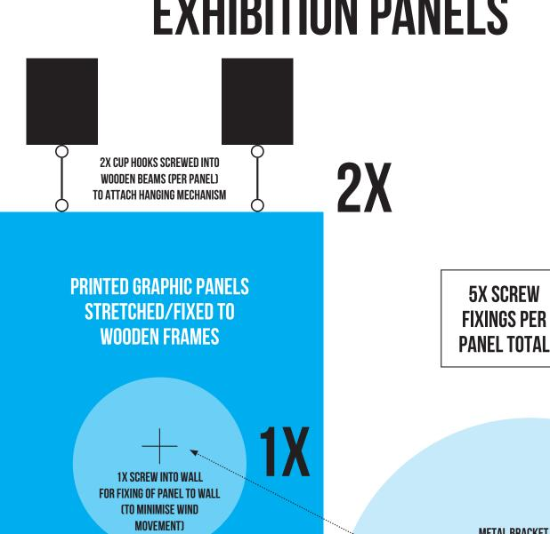
**METAL BRACKET** 8 X 35MM WITH SINGLE SCREW **PLUG FIXING EXHIBITION PANEL SIDE WOODEN BRACKET** WALL VIEW
