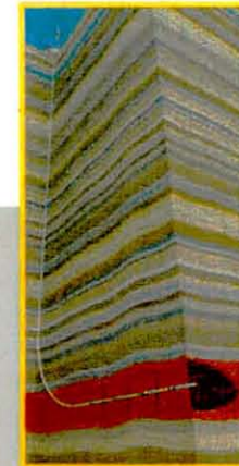
Hidrouliese breking. 'n Staal omhulsel in die boorgat beskerm die oppervlakkige varswaterbronne.
