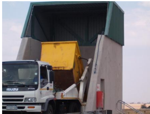
(d) Truck tipping into the compactor.
