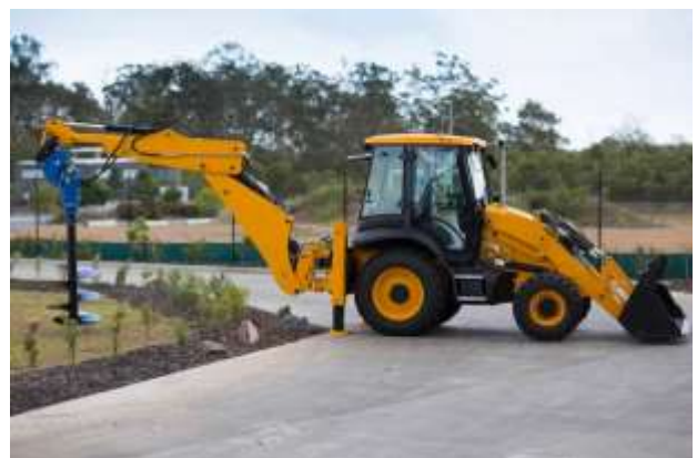
Plaat 1: Voorbeeld van 'n TLB gemonteerde awegaarboor.
